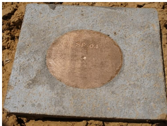
Figura 5: (Monumento topográfico tipo "A")
